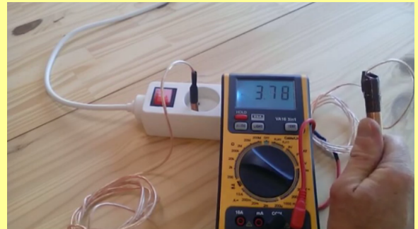
Prise dans la main du barreau, la tension induite dans le corps est de 3,78 Volt
