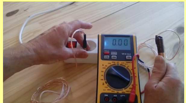
La mise à la terre en touchant le plot de terre de la multiprise permet de décharger le champ électrique induit dans le corps.
