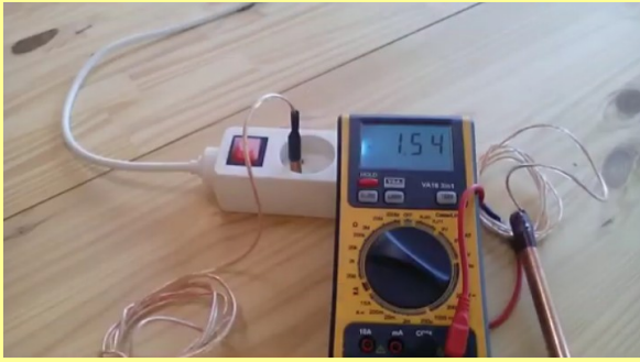
Mesure de 1,54 Volt entre la terre et le barreau de cuivre posé sur la table.
